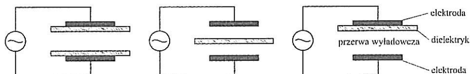
Rys. 2. Typowe konfiguracje elektrod reaktora z wyładowaniami barierowymi Fig. 2. Typical configurations of reactor electrodes with barrier discharges
